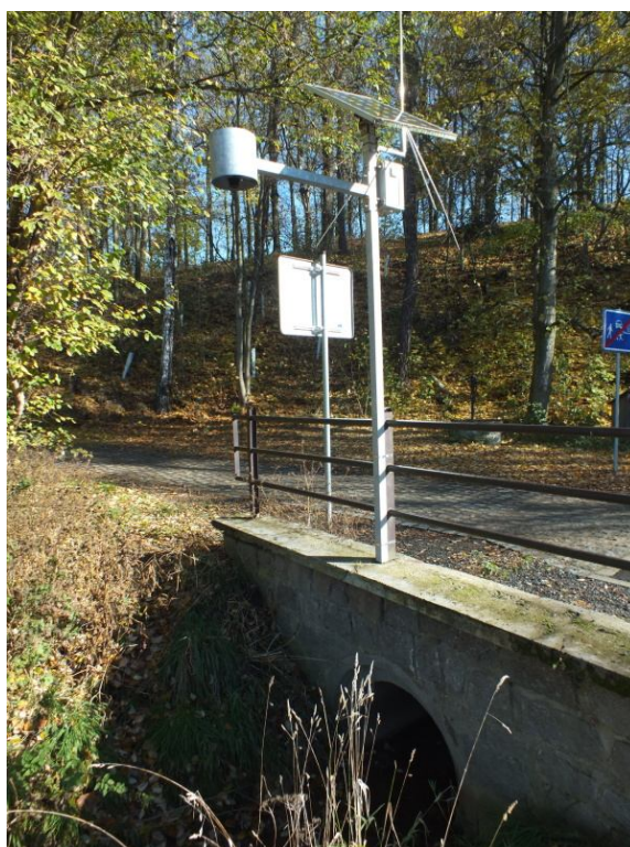
Profil je vybaven ultrazvukovým detektorem výšky hladiny s dálkovým přenosem dat
